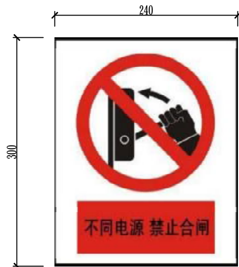
14 "不同电源 禁止合闸" 警告标志牌
