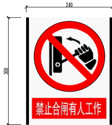
15 "禁止合闸 有人工作" 警告标志牌
